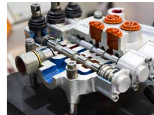
Figur 11-1. En hydraulisk styreventil med mange trange passasjer
