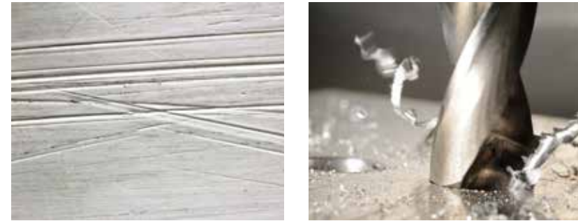
Figur 1-6 Slitasjefurer og abrasiv slitasje ved boring
